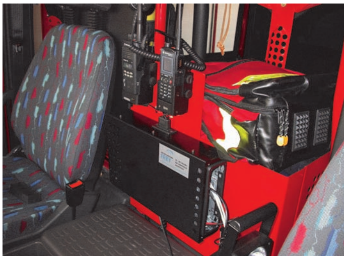
Das eingebaute Digitalfunkgerät im Kastler Löschfahrzeug
