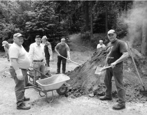
Der Kohlemeileraufbruch und das Herausholen der fertigen Holzkohle war eine sehr trockene und schweißtreibende Arbeit, da die Kohle noch heiß war und mit Wasser am Anbrennen gehindert werden musste. Die Kastler „Hobby-Ruaßln“ meisterten diese Aufgabe mit Bravour.
